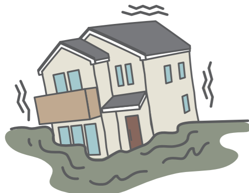
地震による液状化で建物が沈下した
